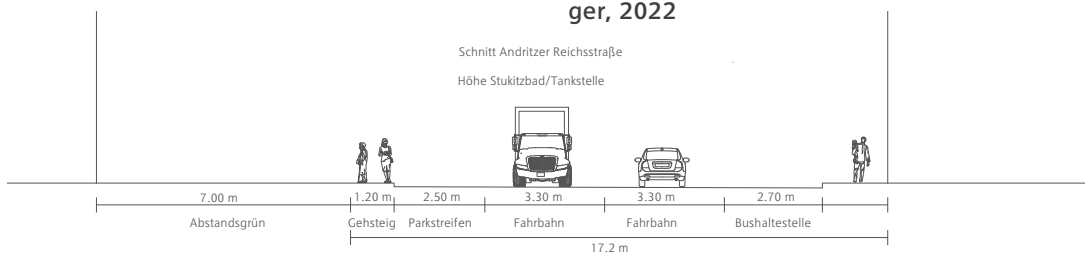
Abb. 7.5: Straßenquerschnitt Andritzer Reichsstraße. Quelle: Kastberger, 2022
