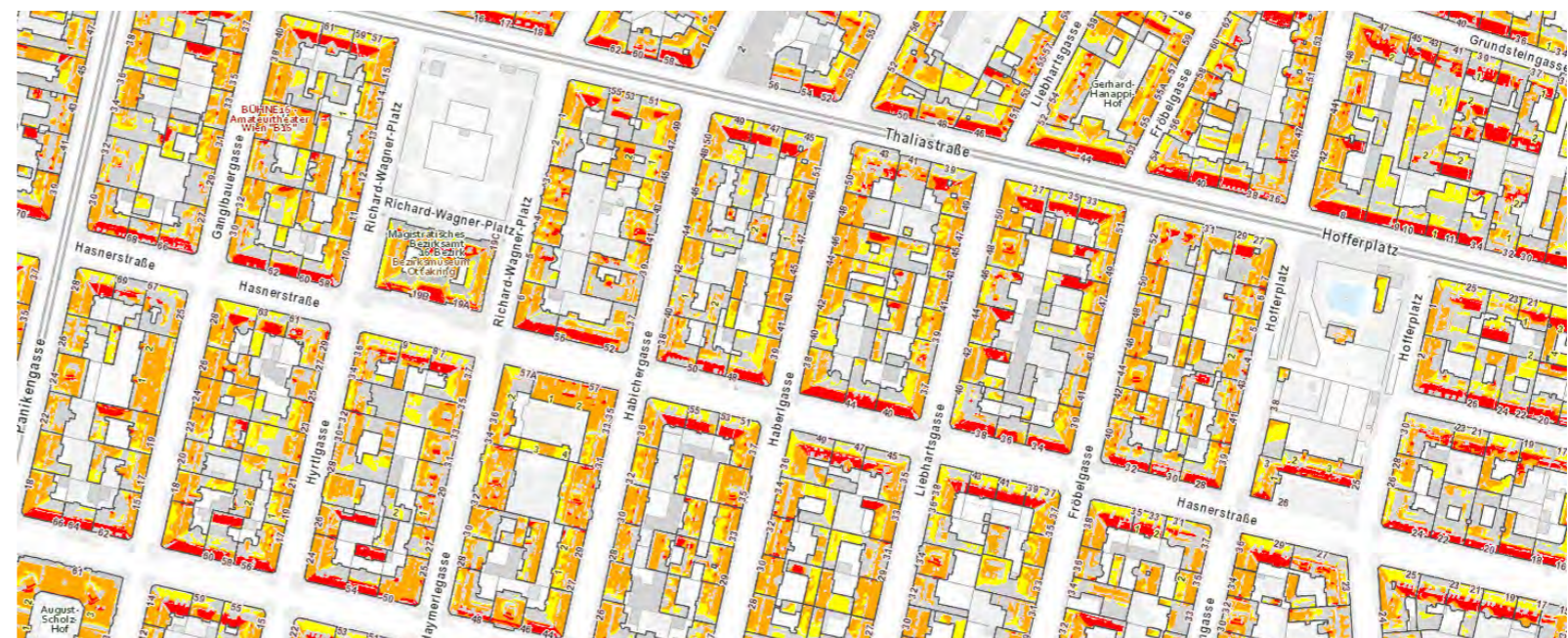
Abb. 148: Ausschnitt des Solarpotenzialkatasers Wiens im 16. Wiener Gemeindebezirk, desto dunkler die Fläche eingezeichnet ist umso geeigneter ist sie, wien.gv.at
